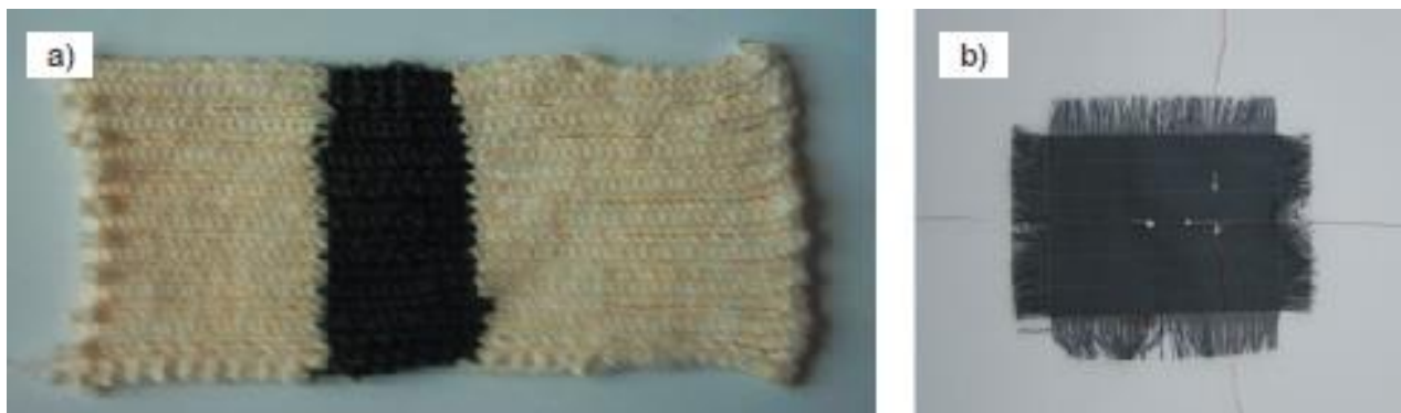
1.6 pav. Tekstiliniai jutikliai su elektrai laidžiais siūlais: a) megztas jutiklis, b) austas jutiklis
