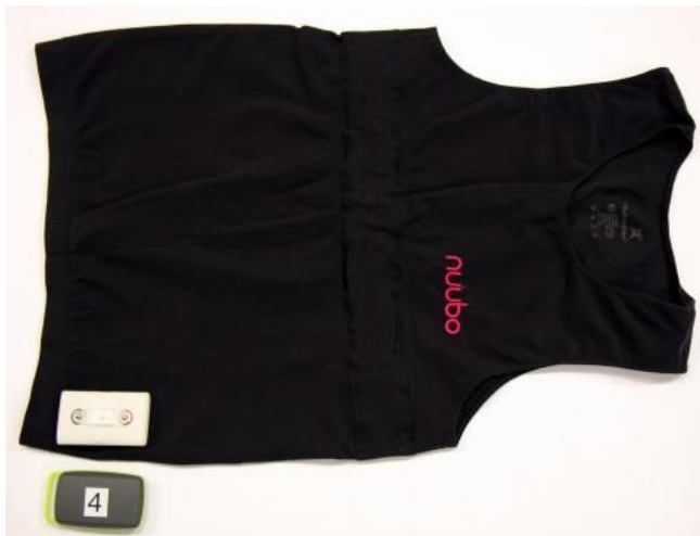
1.35 pav. Skalbiami išmanieji marškinėliai, registruojantys paciento gyvybines funkcijas [28]
