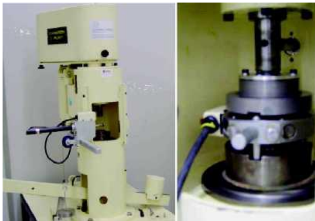
1.1 pav. Guolių tyrimo įrenginys (kairėje), guolių tyrimo įrenginio apkaba (dešinėje) [2]
