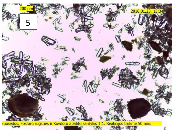
12 pav. Fosfogipso kristalų nuotraukos, esant 80 °C temperatūrai, stochiometriniam santykiui EFR:KA = 1:1 ir desulfatizaciją vykdant 1 – 10; 2 – 20; 3 – 30, 4 – 40; 5 – 50; 6 – 60 min
