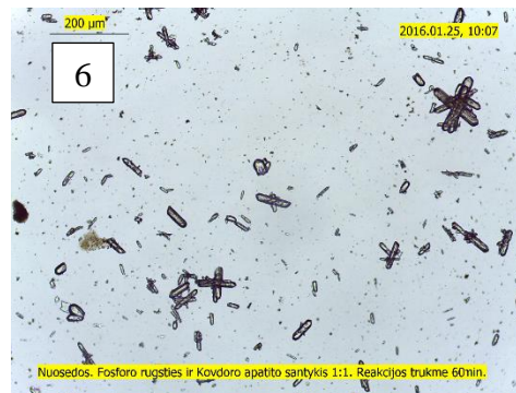
9 pav. Fosfogipso kristalų nuotraukos, esant 90 °C temperatūrai, stochiometriniam santykiui EFR:KA = 1:1 ir desulfatizaciją vykdant: 1 – 10; 2 – 20; 3 – 30, 4 – 40; 5 – 50; 6 – 60 min
