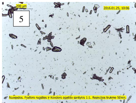
9 pav. Fosfogipso kristalų nuotraukos, esant 90 °C temperatūrai, stochiometriniam santykiui EFR:KA = 1:1 ir desulfatizaciją vykdant: 1 – 10; 2 – 20; 3 – 30, 4 – 40; 5 – 50; 6 – 60 min
