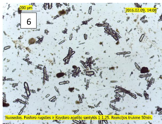
16 pav. Fosfogipso kristalų nuotraukos, esant 70 °C temperatūrai, stochiometriniam santykiui EFR:KA = 1:1,25 ir desulfatizaciją vykdant: 1 – 10; 2 – 20; 3 – 30, 4 – 40; 5 – 50; 6 – 60 min.
