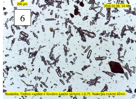
3 pav. Fosfogipso kristalų nuotraukos, esant 70 °C temperatūrai, stochiometriniam santykiui EFR:KA = 1:0,75 ir desulfatizaciją vykdant: 1 – 10; 2 – 20; 3 – 30, 4 – 40; 5 – 50; 6 – 60 min
