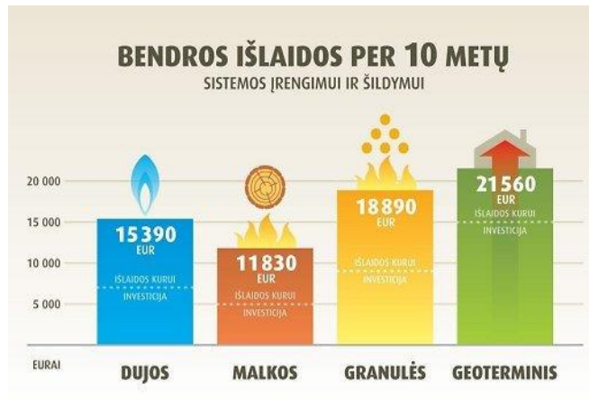
5 pav. Bendros išlaidos per 10 metų skirtingoms šildymo sistemoms
