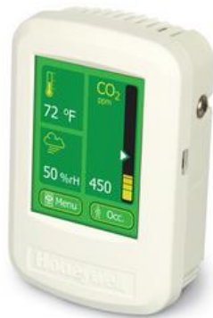
1.3 pav. „IAQPoint2“ patalpų oro kokybės stebėsenos prietaisas [19]
