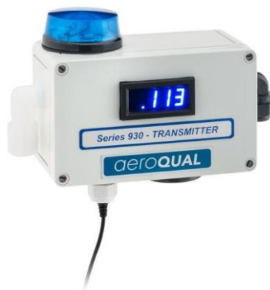
1.2 pav. Stacionarus dujinių teršalų matuoklis „AeroQUAL 930“ [18]
