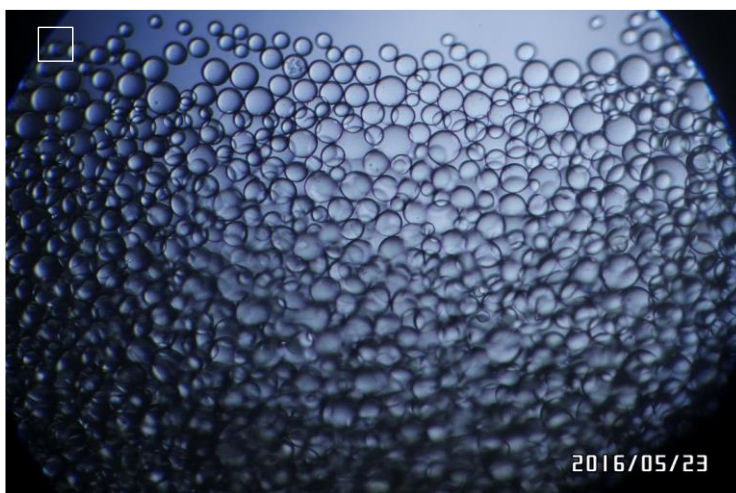
Pav. 38 35 \mu\text{m} žiūrint per mikroskopą padidinus X40 Įterpto kvadrato matmenys yra 100 x 100 \mu\text{m} .
