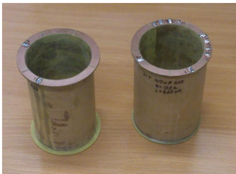
4.1.1 pav. Solenoidinio tipo jutikliai turintys atskirą apviją signalo priėmimui ir protonų poliarizacijai
