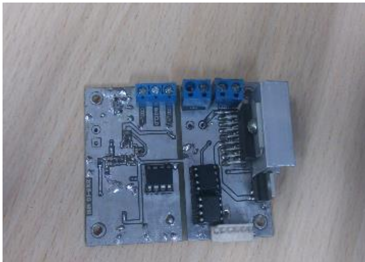
6 pav. Surinktos plokštės paveikslas skirtos PPM su atskira poliarizavimo apvija
