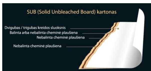
2.3 pav. SUB kartono struktūra [5]
