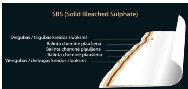
2.2 pav. SBS kartono struktūra [5]
