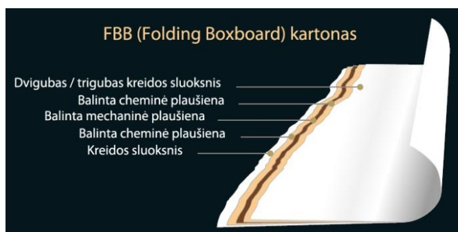
2.1 pav. FBB kartono struktūra [5]
