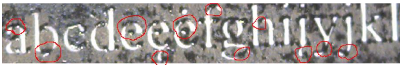
45 pav. Vienspalvis negatyvinis tekstas. Dingę raidžių elementai, spausdinant 2 pt dydžio šrifto
