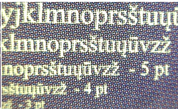
72 pav. Negatyvinis C50%M50%K50% tekstas. Dėl sutapdinimo netikslumo bei rastrinių taškų išsidėstymo pablogėjęs mažo dydžio teksto skaitomumas (3÷7pt)
