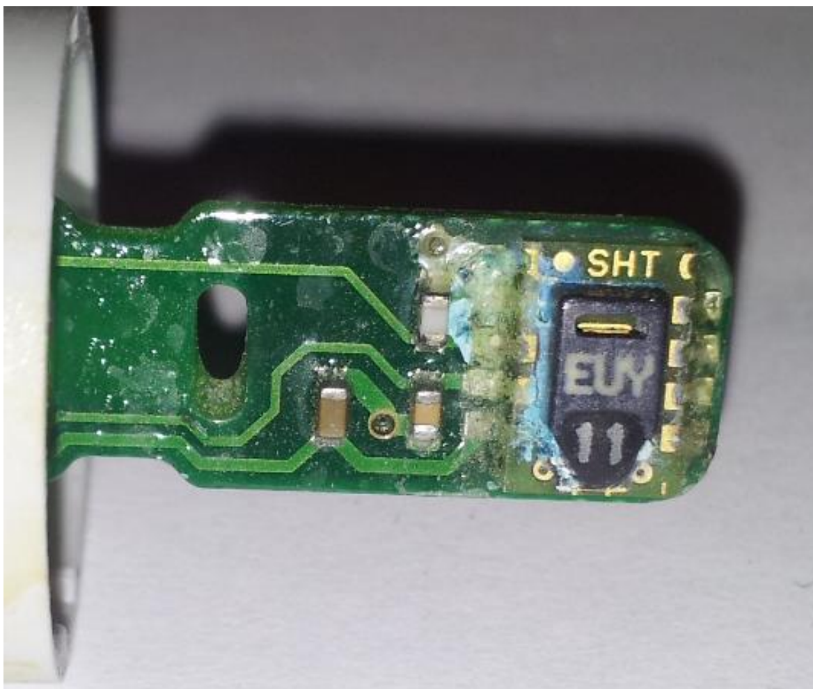
3.4 pav. Santykinės drėgmės matavimo jutikli „292-1424-00“ paveiktas drėgmės
