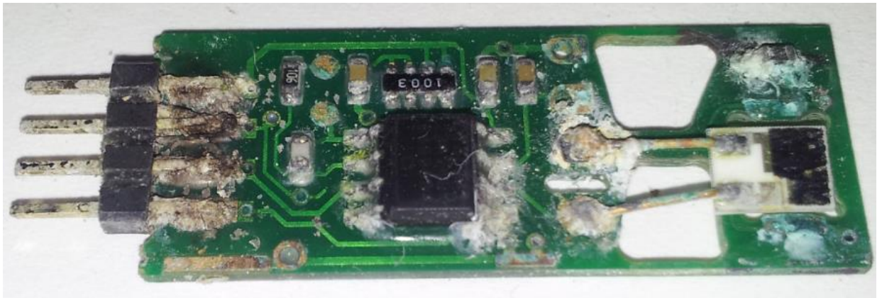
3.5 pav. Santykinės drėgmės matavimo jutiklis „Dixell XH20P“ paveiktas drėgmės
