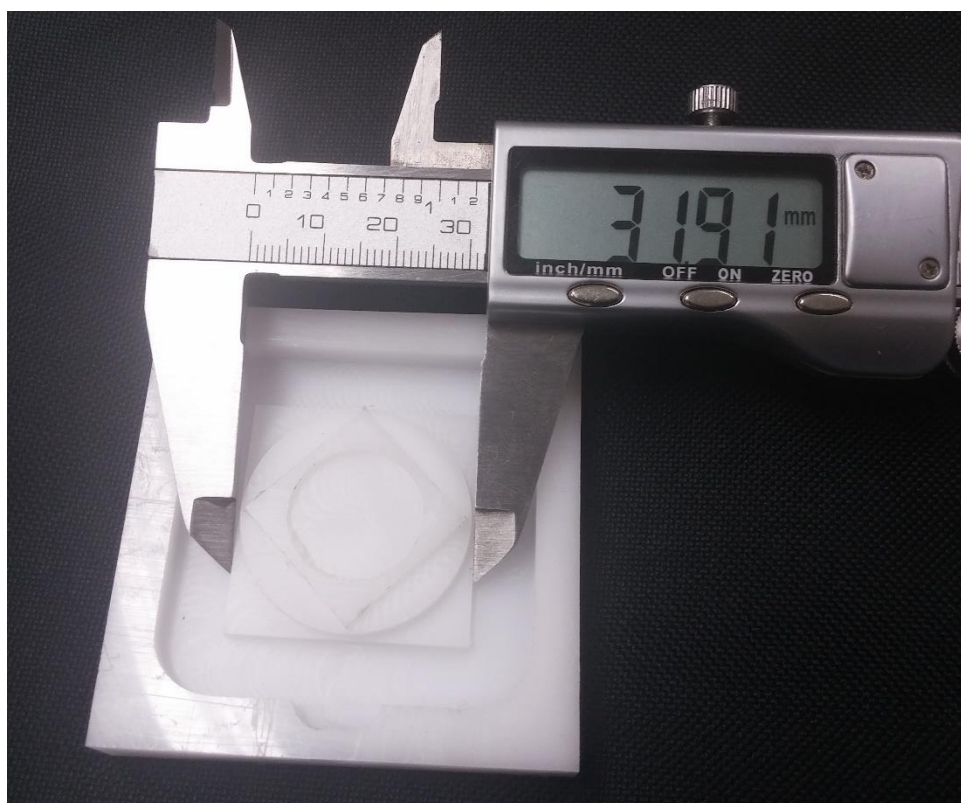
64. pav. Detalės matavimas su slankmačiu
