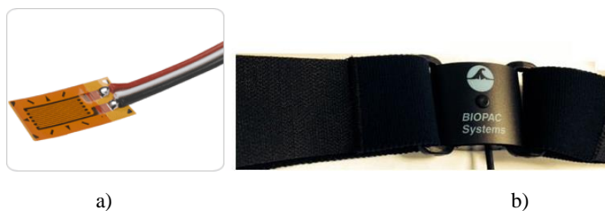
1.3 pav. Tenzo jutiklis pavyzdys [8] a), kvėpavimo registravimo diržas su integruotu tenzo jutikliu [9] b)
