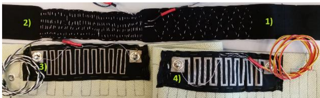
3.3 pav. Kvėpavimo jutikliai: 1) laidinis zigzag formos 2) laidinis meandro formos 3) tekstilinis meandro formos su siaurais takeliais 4) tekstilinis meandro formos su plačiais takeliais
