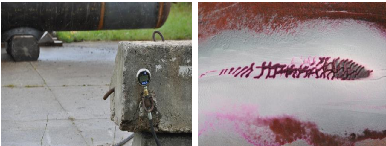
1.8 pav. Hidraulinio bandymo metu sferinės aklės metalo atisluoksniavimas
