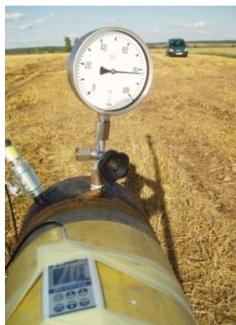
1.5 pav. Panevėžio dujų skirstymo stoties dujotiekis su užvirintomis aklėmis
