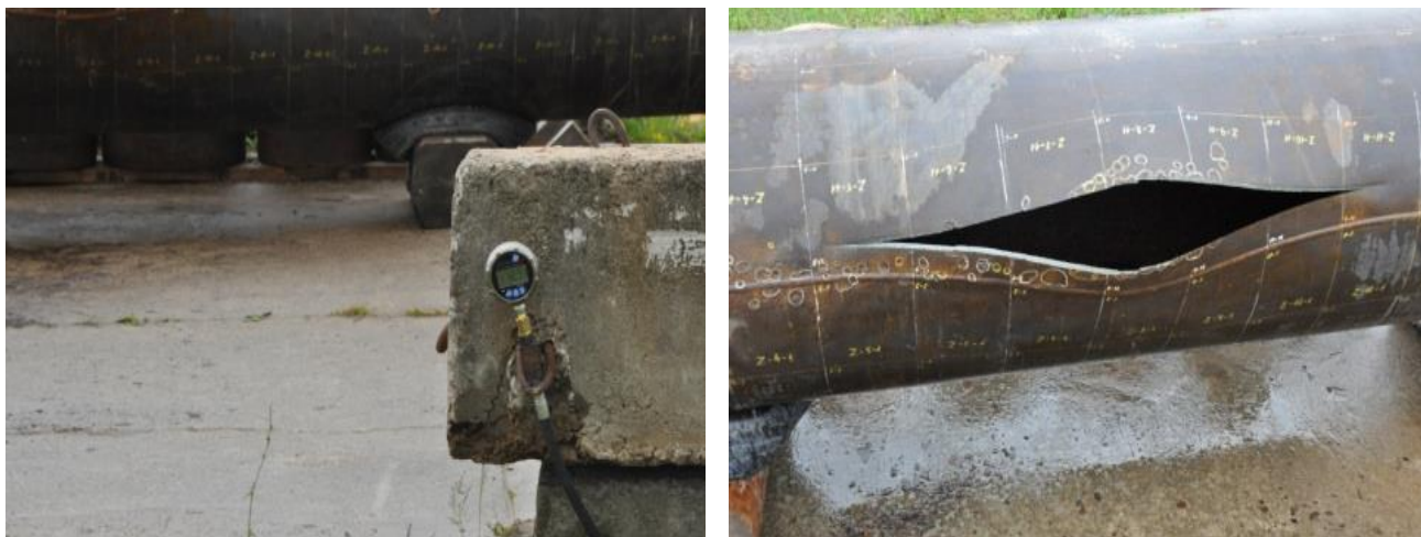
1.7 pav. Hidraulinio bandymo metu trūkęs dujotiekio vamzdynas
