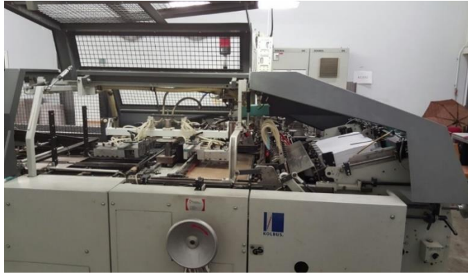
14 pav. Kieto įrišimo knygų viršelių gamybos mašina Kolbus DA 240 chronos
