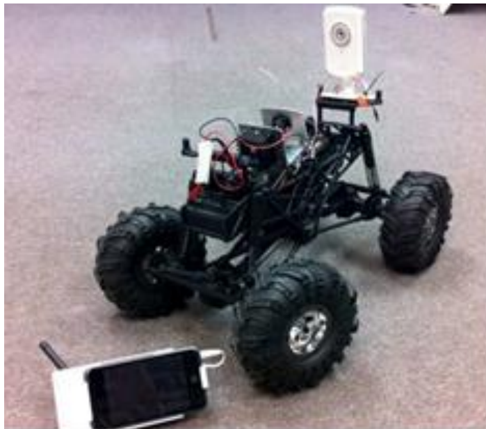
1 pav. Mobilus robotas, valdomas iPhly [1]
