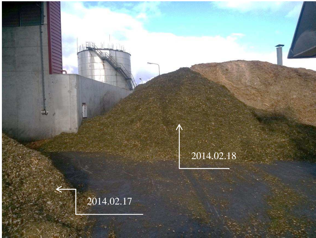
2.6 pav. Bandymams naudotas skirtingos frakcijos ir drėgnumo kuras
