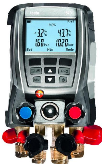
4.6 pav. Testo firmos prietaisas kompresoriaus parametrams analizuoti
