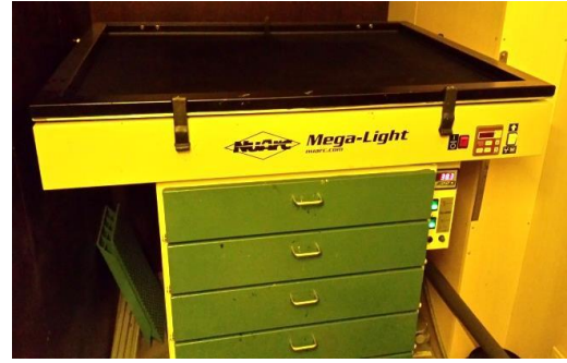
13 pav. Eksponavimo procesas UV spinduliais „NuArc Mega-Light” įrenginiu
