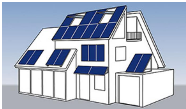
1.5 pav. Saulės elektrinių montavimo galimybės ant gyvenamojo namo
