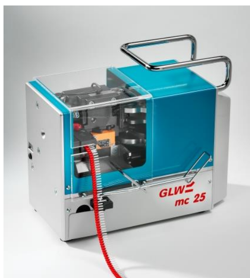
1.8 pav. GLW elektrinis laidų nužievinimo ir antgalių uždėjimo įrenginys
