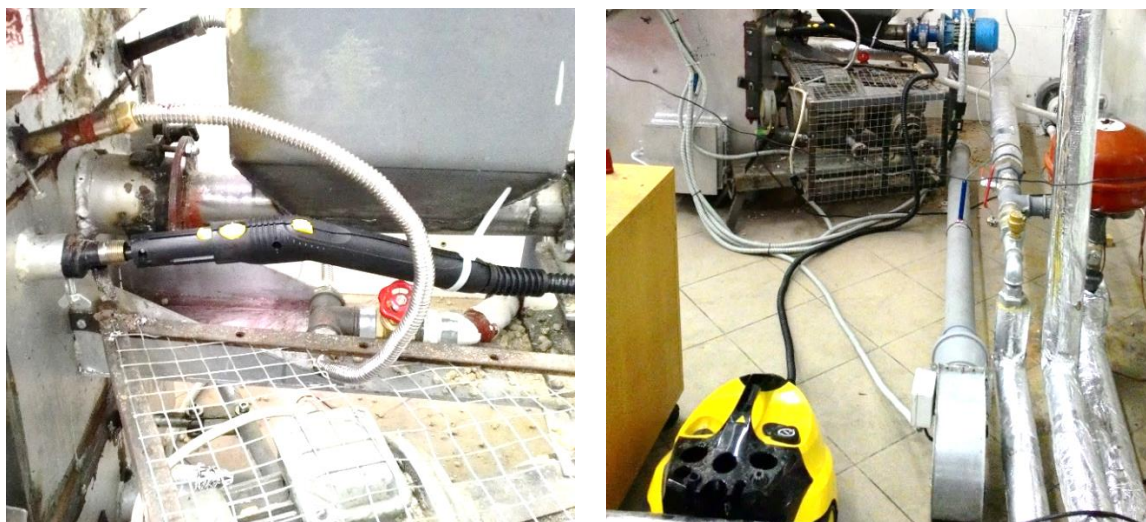
3.1.9 pav. Garo tiekimo sistema
