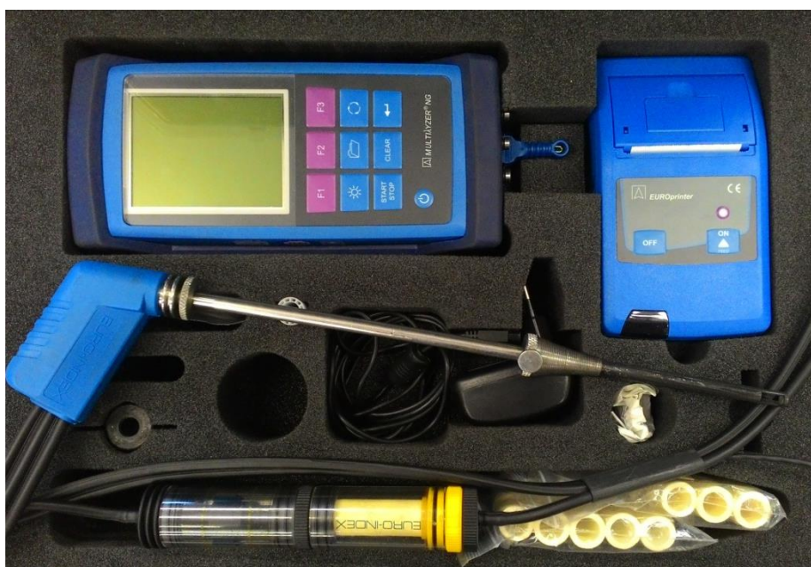
3.1.3 pav. Dūmų sudėties analizatorius Multilyzer NG su matavimo zondų
