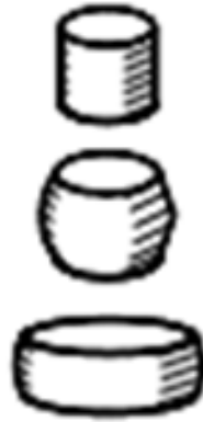
3.6 pav. Trinties įtaka bandinio formai [25]
