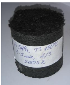
2.12 pav. Presuotų gumos granulių ruošinys.
