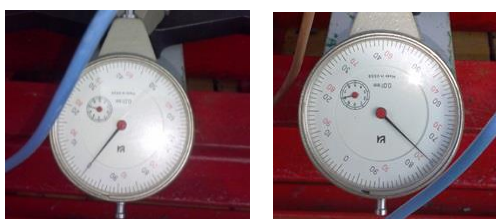
2.10 pav. Dinamometro rodmenys: pav a - presavimo pradžioje, pav. b – suslėgus gumą
