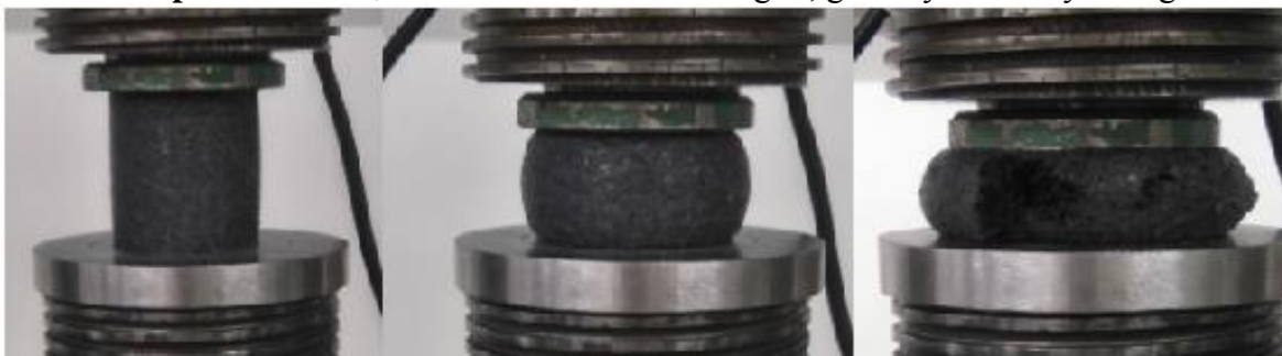
2.17 pav. Bandinio, formuoto esant 5 MPa slėgiui, gniuždymo bandymo eiga
