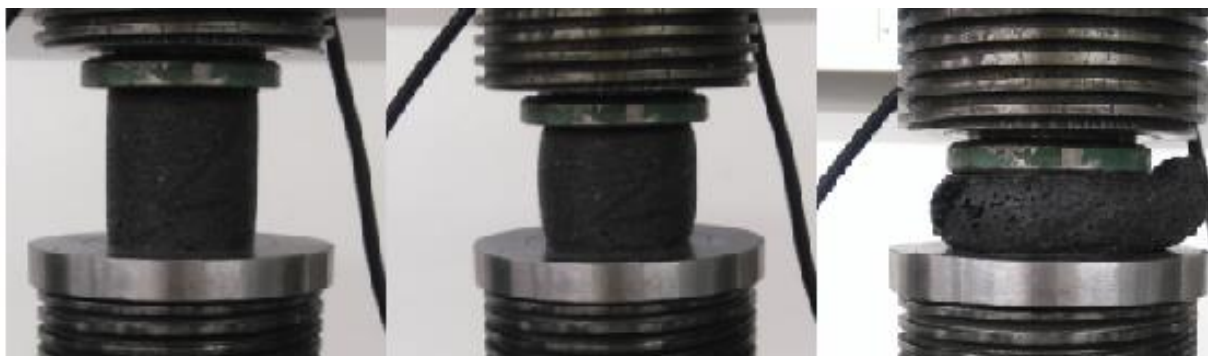
2.14 pav. Bandinio, formuoto esant 2 MPa slėgiui, gniuždymo bandymo eiga
