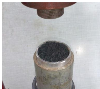
2.9 pav. Spaudimo forma pripildyta gumos granulėmis
