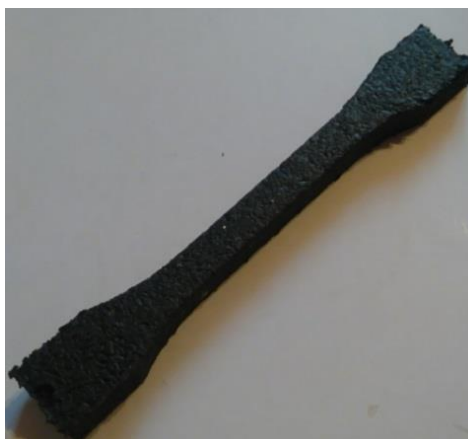
2.31 pav. Presuotų gumos granulių bandinys tempimo bandymams
