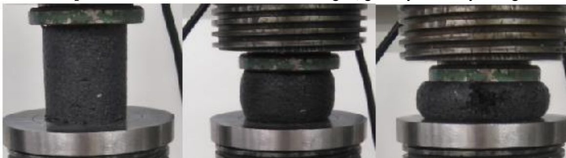
2.16 pav. Bandinio, formuoto esant 4 MPa slėgiui, gniuždymo bandymo eiga
