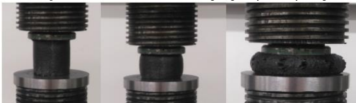
2.18 pav. Bandinio, formuoto esant 6 MPa slėgiui, gniuždymo bandymo eiga
