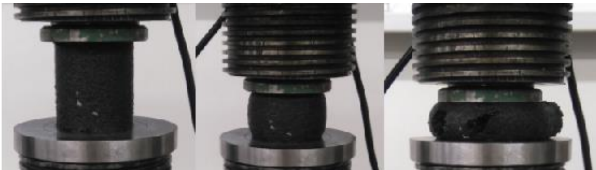
2.15 pav. Bandinio, formuoto esant 3 MPa slėgiui, gniuždymo bandymo eiga
