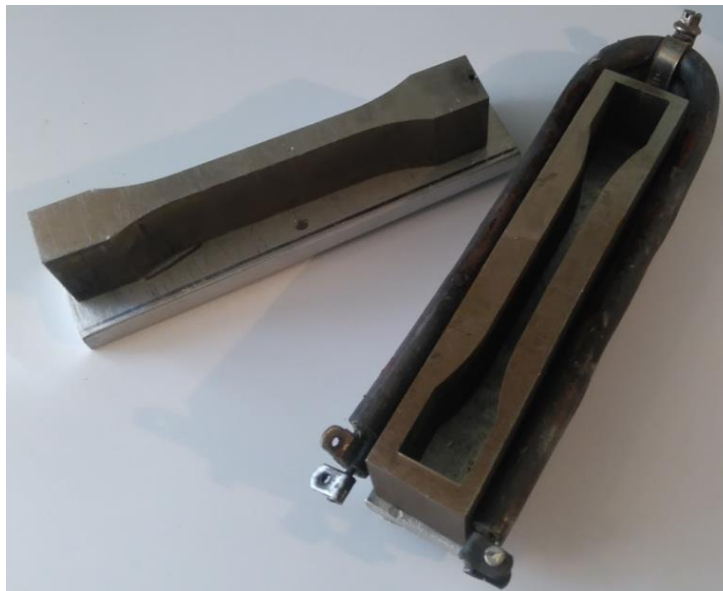
2.29 pav. Forma su katinimo elementu
