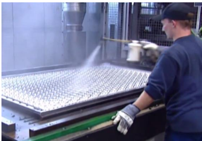
1.4 pav. Formos padengimas silikono purškalu [5]
