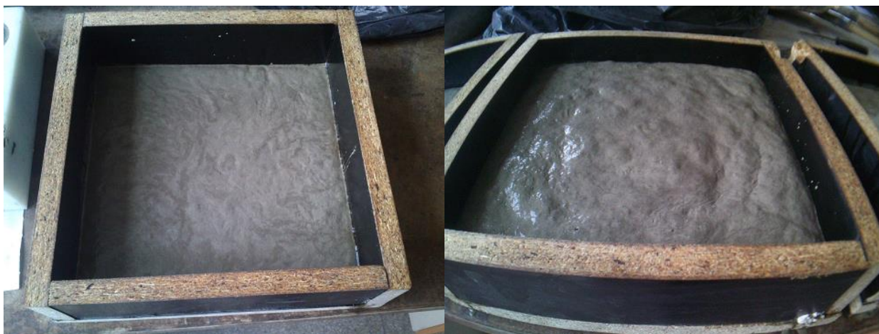
22 pav. Kairėje – supiltas bandinys. Dešinėje toks pat bandinys po 1,5 valandos.
