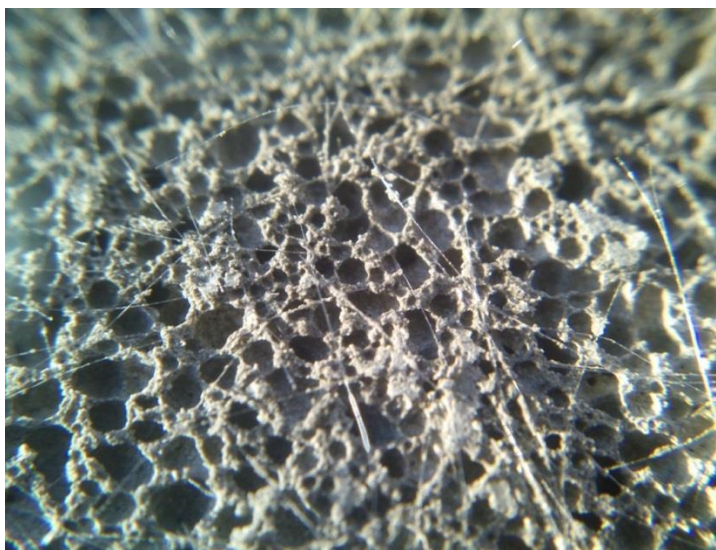
23 pav. Sukietėjusio bandinio porėta struktūra. a) Natūralus dydis, bandinio paviršius. b) Atskelta ir 5 kartus išdidinta, bandinio dalis. Matyti vidinė struktūra.
