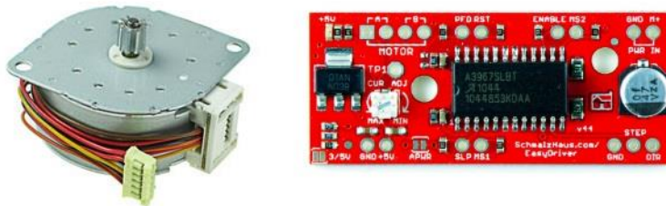
14 pav. Žingsninis variklis (kairėje) ir EasyDrive 4.4 valdiklis (dešinėje)
