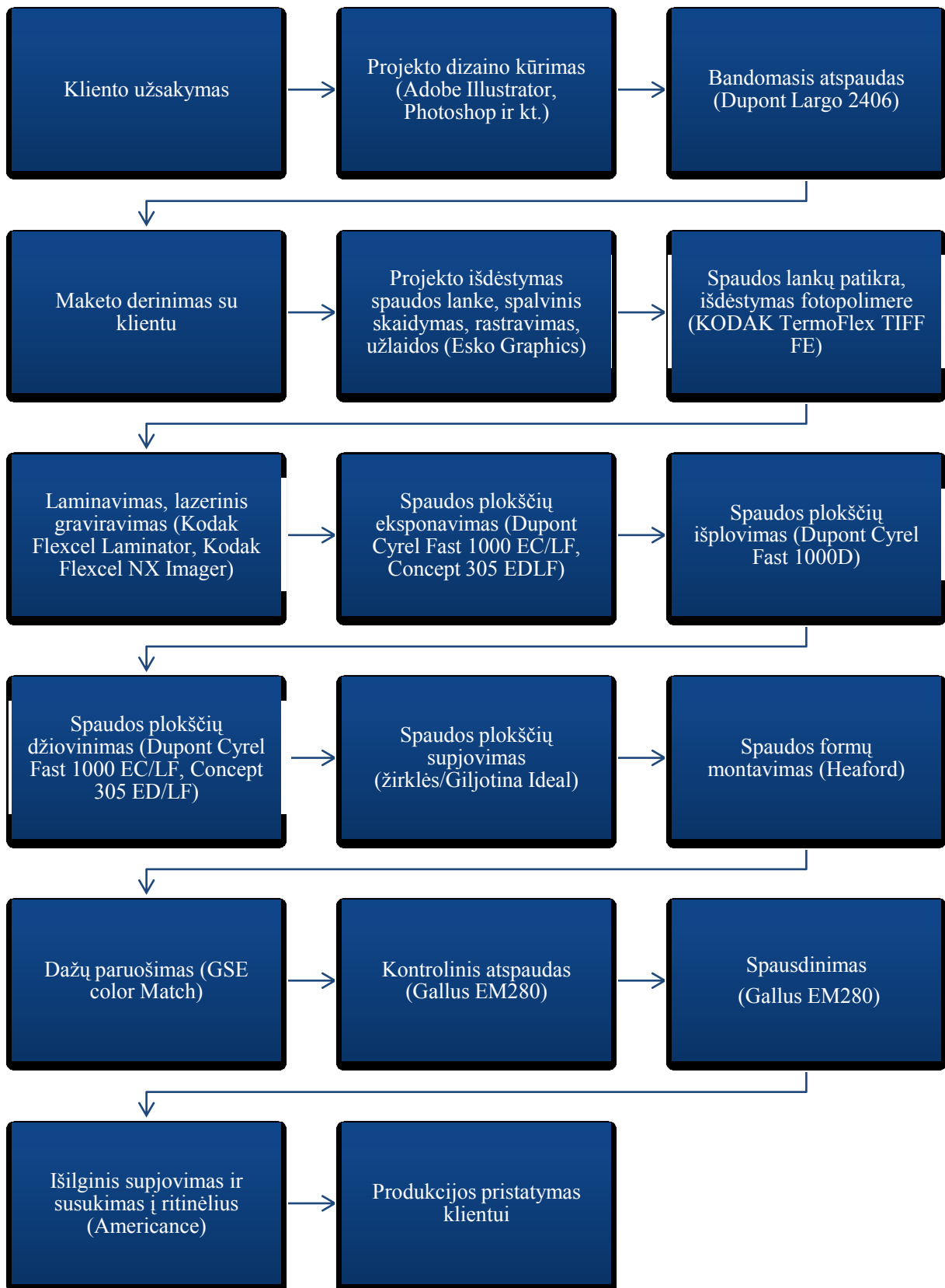
3.2. pav. Lipnių etikečių gamybos technologijos schema.
