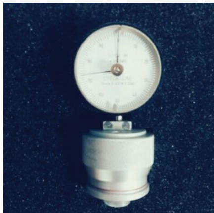
16 pav. Tyrimui atlikti naudotas kietmatis „DUROMETER HPSA-M“
