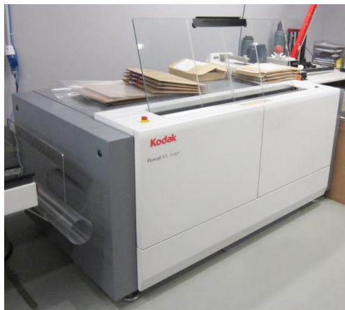
2 pav. Lazerinis eksponavimo įrenginys „KODAK Flexcel Imager“ [10]
