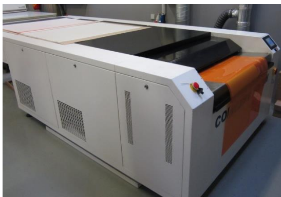
5 pav. Plovimo įrenginys „CONCEPT 305 DW“ [10]
