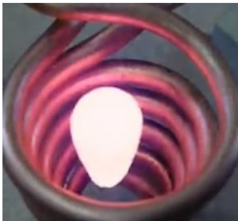
1 pav. Levituojantis ir lydomas aliuminio gabalėlis [4]
