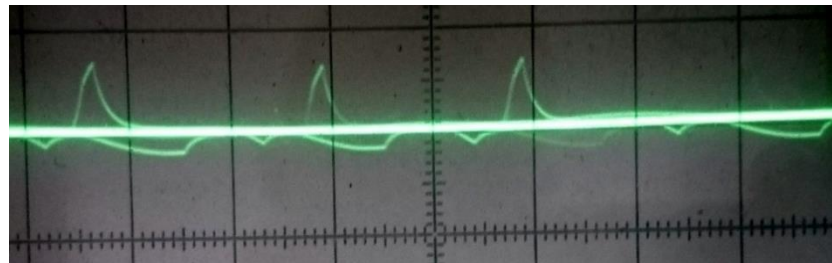
2.11 pav. Įtampos grafikas, osciloskope, sistemoje su kondensatoriais
