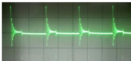
2.20 pav. Aukštos įtampos impulsai, 2.9 pav. schema, valdant IGBT elementui, bei 4 diodu schema.
