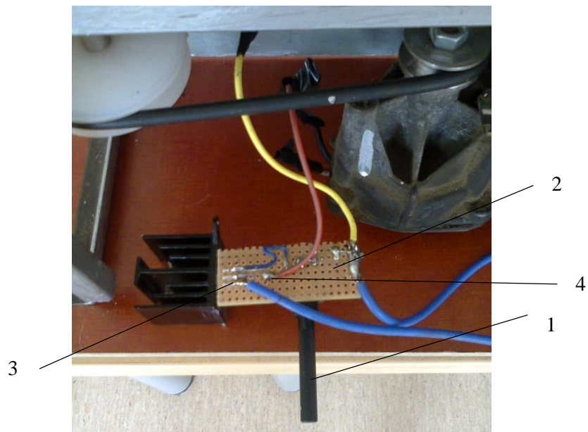
11b pav. Reklaminio stendo greičio valdymo blokas: 1-reguliuojama varža/potenciometras; 2-montažinė plokštė; 3- įtampos reguliatorius mikroschemai LM317; 4-240 omų varža.
