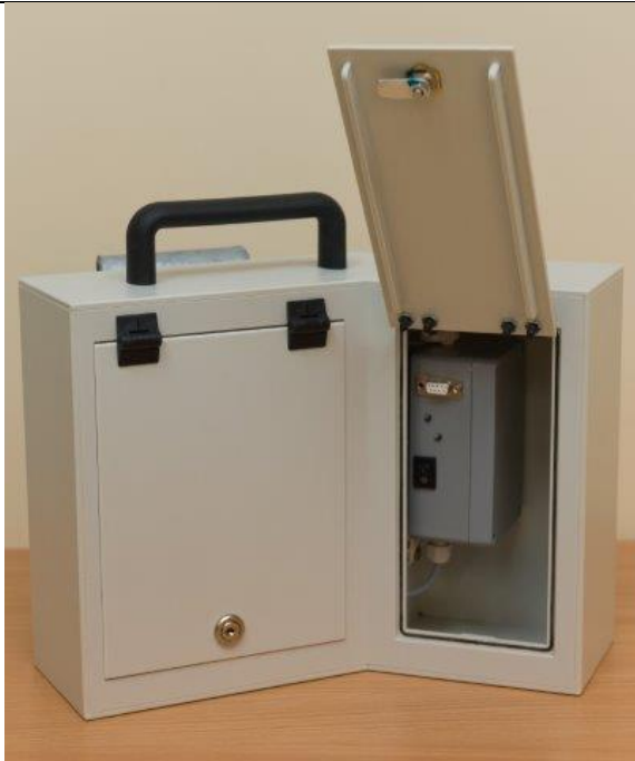
2.3 pav. Mikrobangų matavimo prietaisas „Viacount II“ [14]
