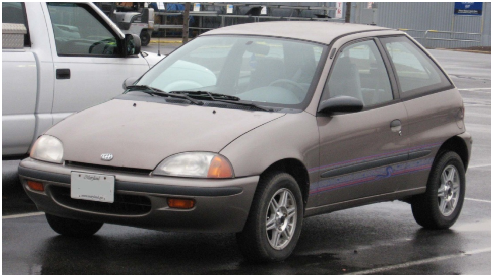
26 pav. GeoMetro automobilio modelis naudojamas TB11 bandyme, kurio masė – 900kg, greitis – 100km/h [17].
