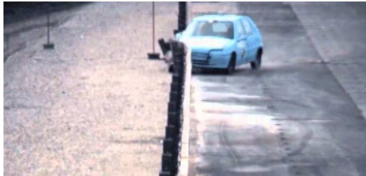
21 pav. Realus TB11 bandymo nuotrauka kai automobilis 900kg, važiuoja 100km/h ir trenkėsi 20 laipsnių kampu į betoninį atitvarą [28]
