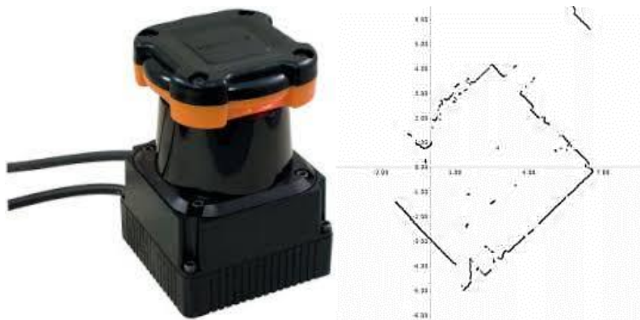
8 pav. Hokuyo UTM-30LX lazerinis atstumo skeneris ir su juo atliktas matavimas[5]
