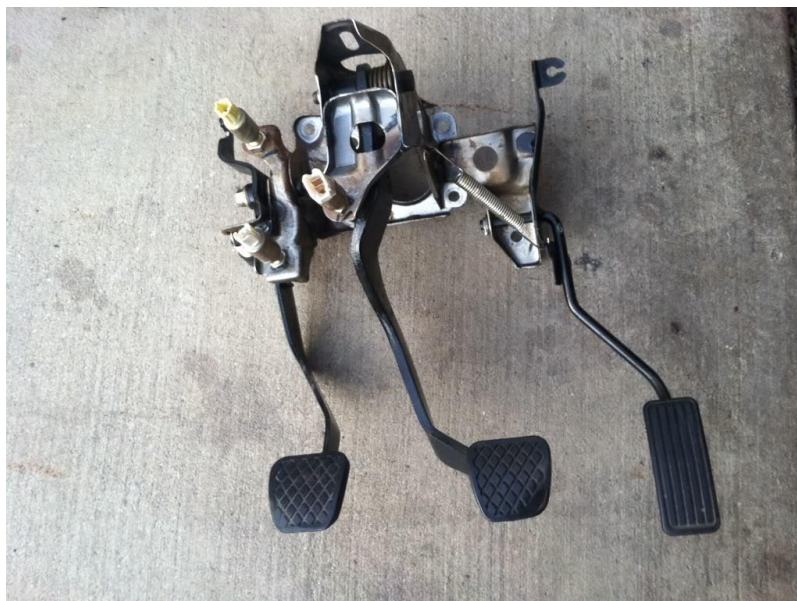
40 pav. Automobilio „Honda“ pedalų konstrukcija [10]
