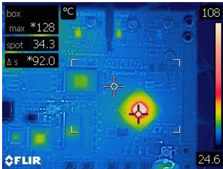
2.5.2.7 pav. Cyclone III maketo temperatūrinio profilio nuotrauka, kai ŽO įjungtas
