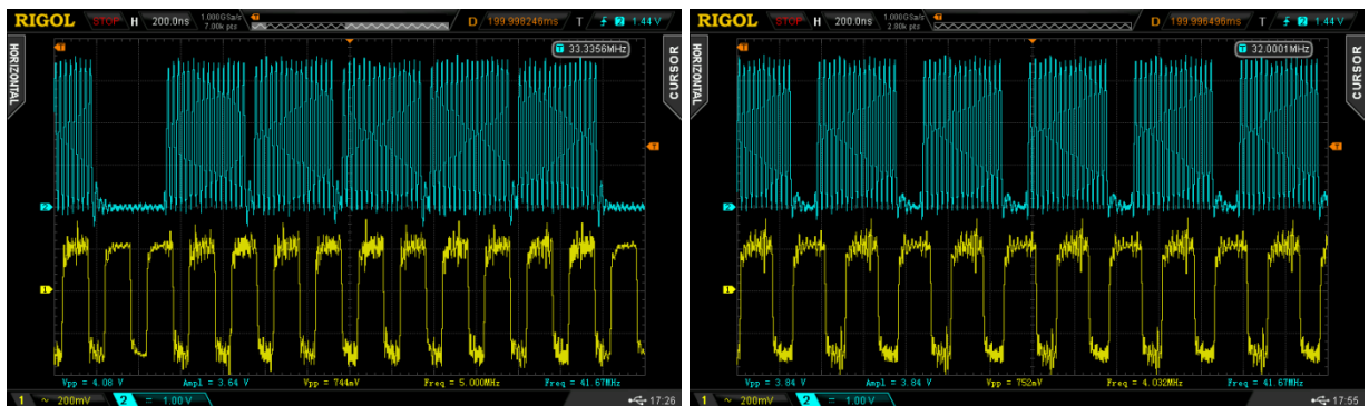
72 pav. Kairėje – bandymas perduoti duomenis SPI sąsaja 5 MB/s sparta; dešinėje 4 MB/s
