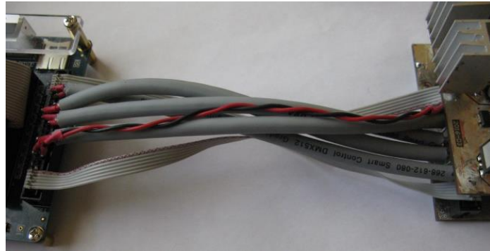
69 pav. 100 \Omega impedanso kabelis, perduoti duomenims iš keitiklio į FPGA matricą
