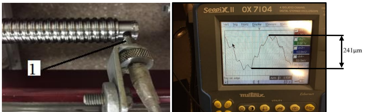
3.3.1 pav. X ašies sraigto galo poslinkio matavimas radialine kryptimi
