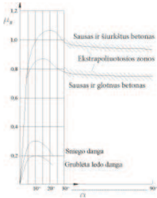
1.5.2.8 pav. Šoninės krypties sukibimo koeficientai pagal ratų pasukimo kampą ir kelio dangą [1]
