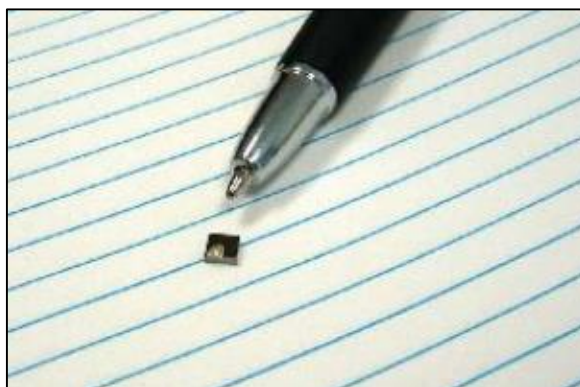
5 pav. Jutiklis naudojamas acetileno dujų koncentracijai transformatoriuje nustatyti
