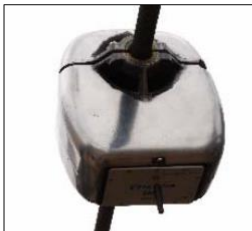
6 pav. Prie laidininko tvirtinamas temperatūros jutiklis duomenis perduodantis GPRS ryšiu
