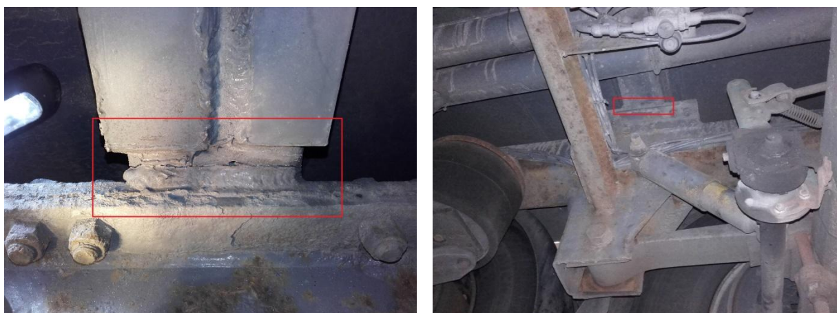
4.2 pav. Autocisternos rėmo pažeidimai dėl nuovarginio proceso
