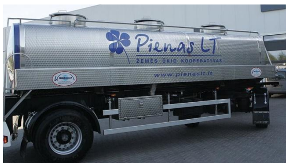
1.2 pav. Maistinė autocisterna pienui
