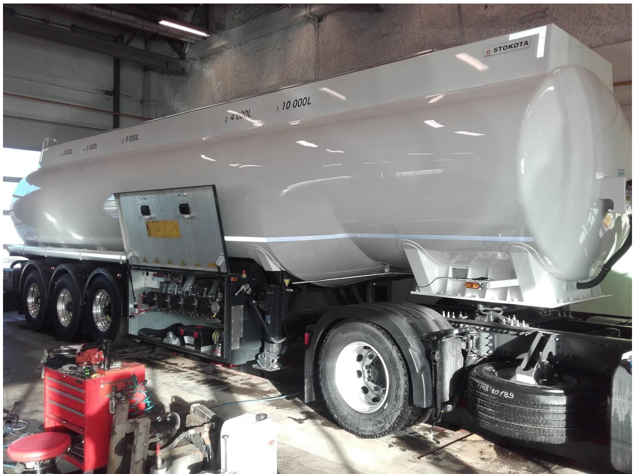
2.3 pav. Nauja, katik iš Stokota gamyklos išriedėjusi, 5 sekcijų naftos produktams skirta autocisterna
