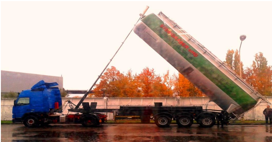
1.13 pav. Silo-cisternos. Schema ir darbo režimas
