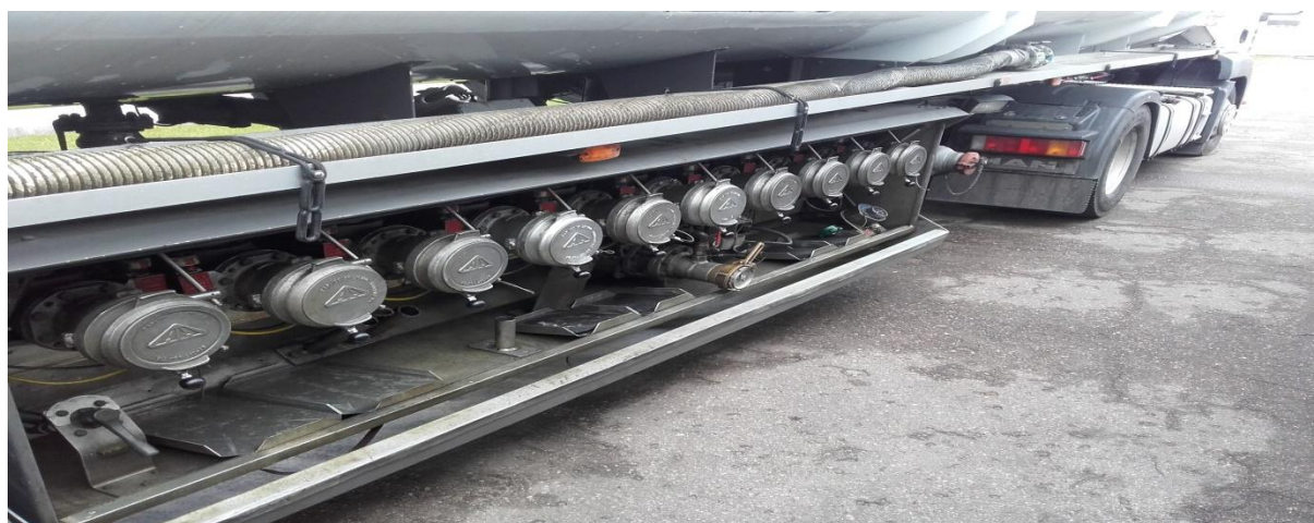
1.5 pav. 10 sekcijų pakrovimo-iškrovimo sistema
