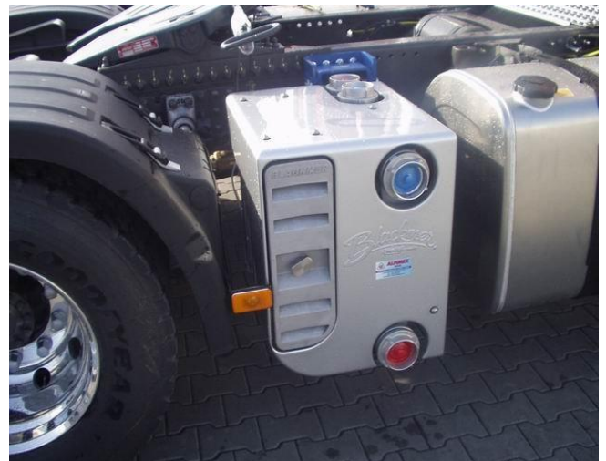
1.12 pav. Blackmer kompresorius su hydrive hidrauliniiais elementais
