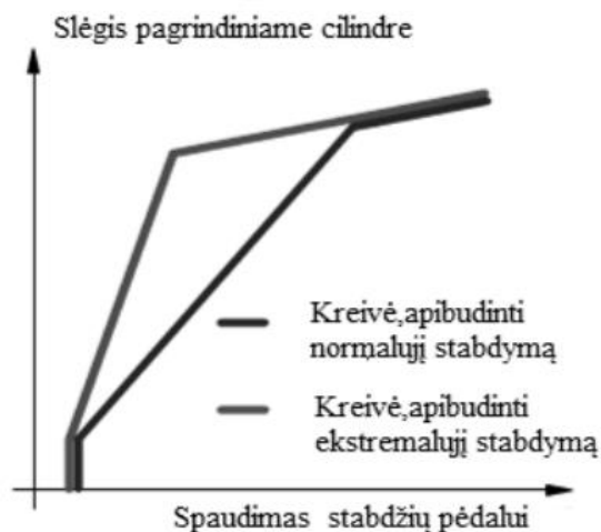
6.1 pav. E.V.A. sistemos veikimo kreivės, apibūdinančios normalųjį ir staigųjį stabdymą [6]
