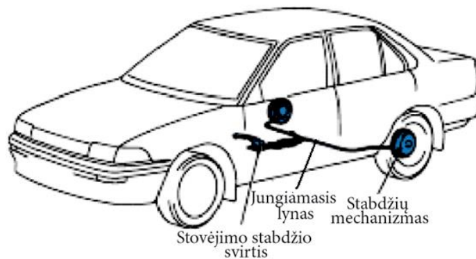
1.1.2.pav. Mechaninė stabdžių pavara [1]
