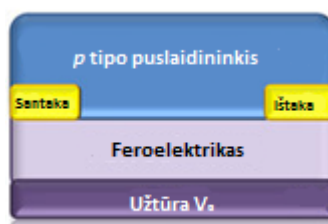
2.13 pav. Feroelektrinio tranzistoriaus schema [68]
