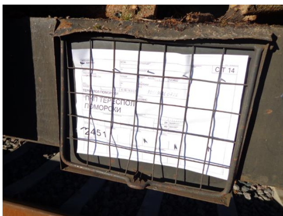
15 pav. Lenkiško vagono dokumentų tvirtinimo pavyzdys.
