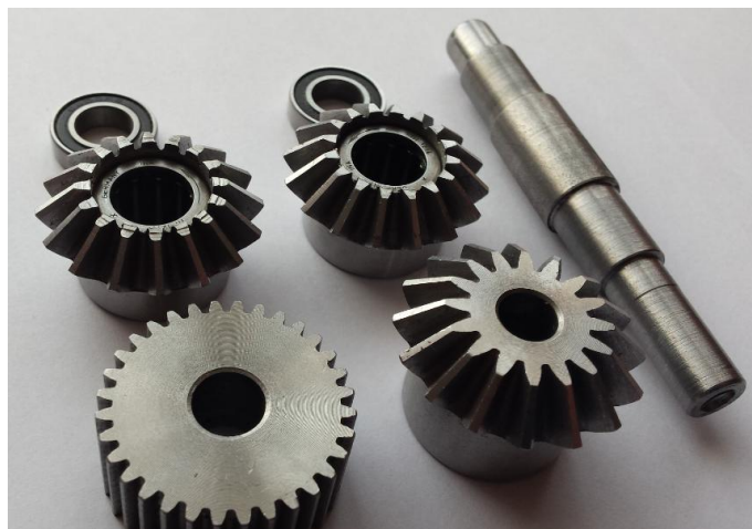
3.9 pav. Apdirbti prototipo pavaros elementai
