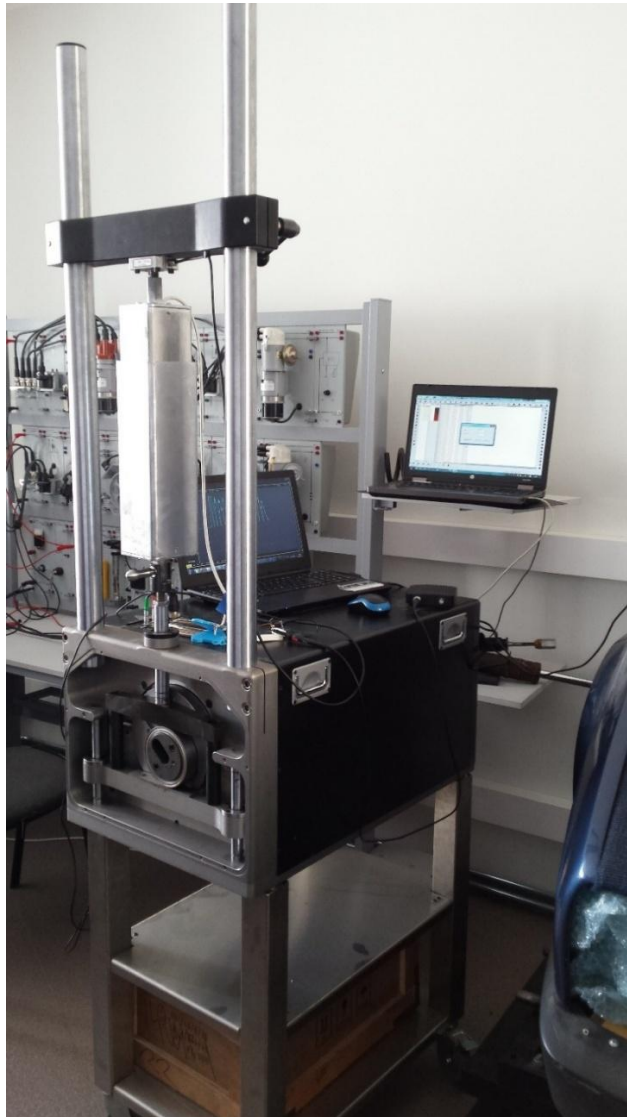
4.1 pav. Prototipo bandymas transporto priemonių pakabų slopinančių elementų charakteristikų tyrimų stende „Shock absorber dynamometer BTP 2000“
