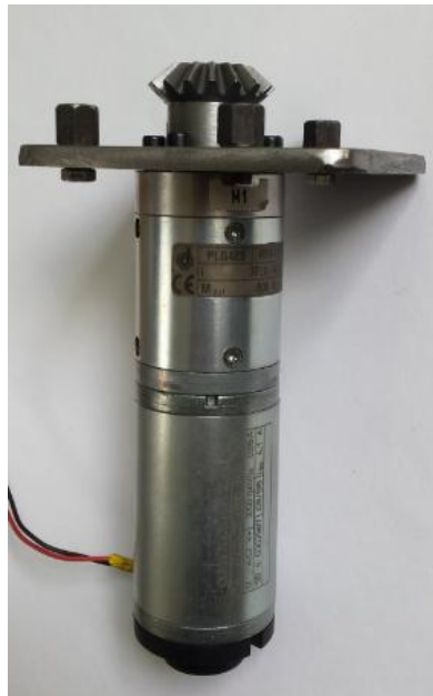
3.8 pav. Nuolatinės srovės variklis „Dunkermotoren G42x25“
