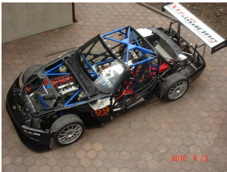
20 pav. Lenktyninis automobilis sukurtas Honda S2000pagrindu. Šasi vaizdas iš viršaus[28]
