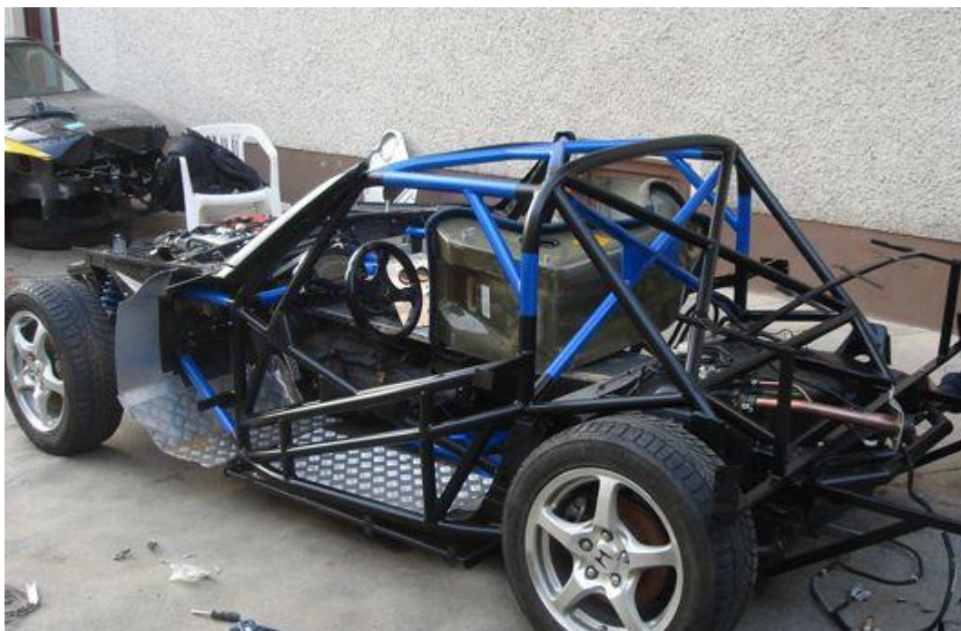
21 pav. Lenktyninis automobilis sukurtas Honda S2000 pagrindu. Šasi vaizdas iš šono[28]
