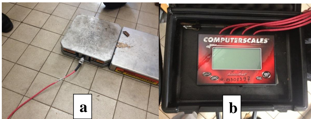
2.8 pav. „Longacre Computerscales“ skaitmeninės svarstyklės: a – svarstyklių padas; b – svarstyklių ekranas
