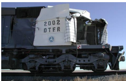
7 pav. Lokomotyvo žala po susidūrimo [13]
