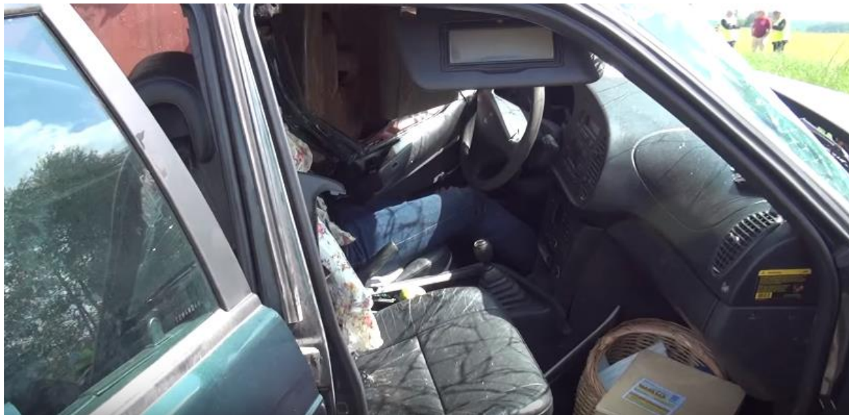
23 pav. Automatinės sankabos galvutės padėtis po smūgio [26]
