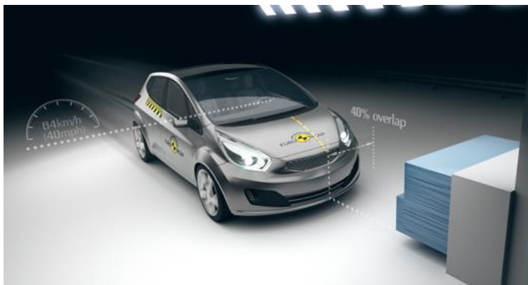
1.18 pav. Frontalinio smūgio testas esant 40 % persidengimui [22]
