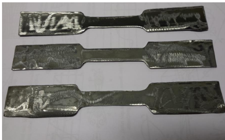
2.9 pav. Pradiniai plieno ruošiniai prieš tempimą
