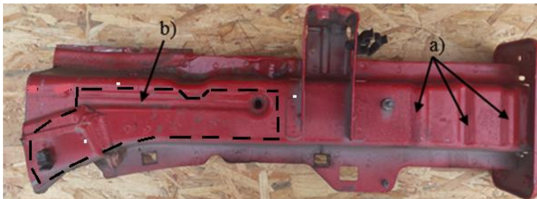
2.5 pav. „Opel Corsa D“ priekinis lonžeronas: a) geometrijos nuokrypiai; b) standumo briauna; punktyrais pažymėta stiprintuvo vieta
