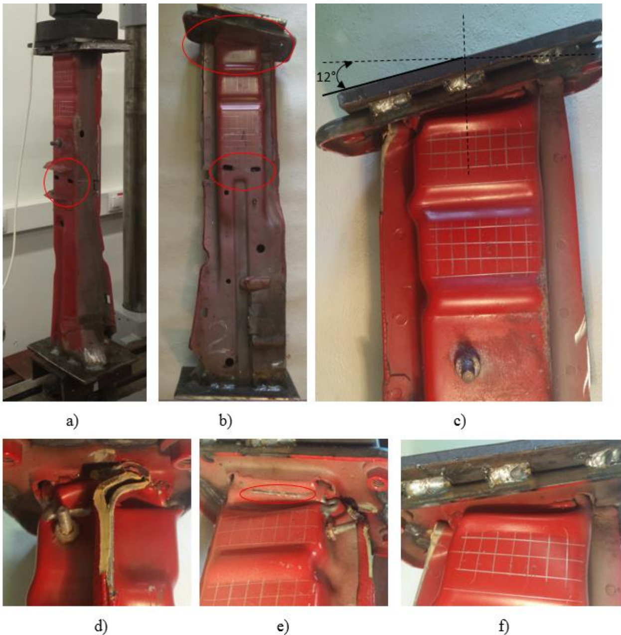
2.20 pav. Modifikuoto ruošinio deformacijos: a) prieš bandymą; b) po bandymo; c) pagrindinė klūpimo zona; d) deformacija tarp lonžerono profilio skardų; e) įturkimai ties siūle; f) deformacinės zonos suklypimas
