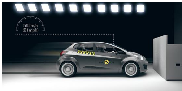
1.19 pav. Frontalinio smūgio testas esant 100 % persidengimui [22]
