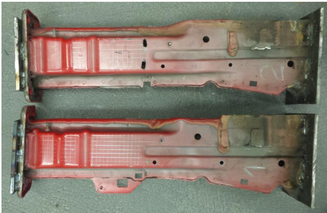
2.16 pav. Klūpdymui paruošti bandiniai
