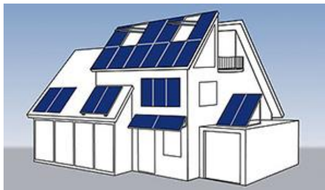
2 pav. Integruota saulės elektrinė ant pastato [3]
