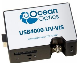
14 pav. UV-Vis spektrofotometras „Ocean Optics USB4000 UV-VIS“ [12]
