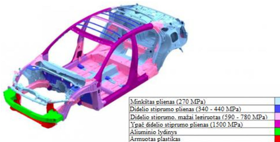
1.6 pav. Automobilio Honda Civic laikančioji konstrukcija su pavaizduotomis skirtingo stiprumo metalų panaudojimo vietomis [24]
