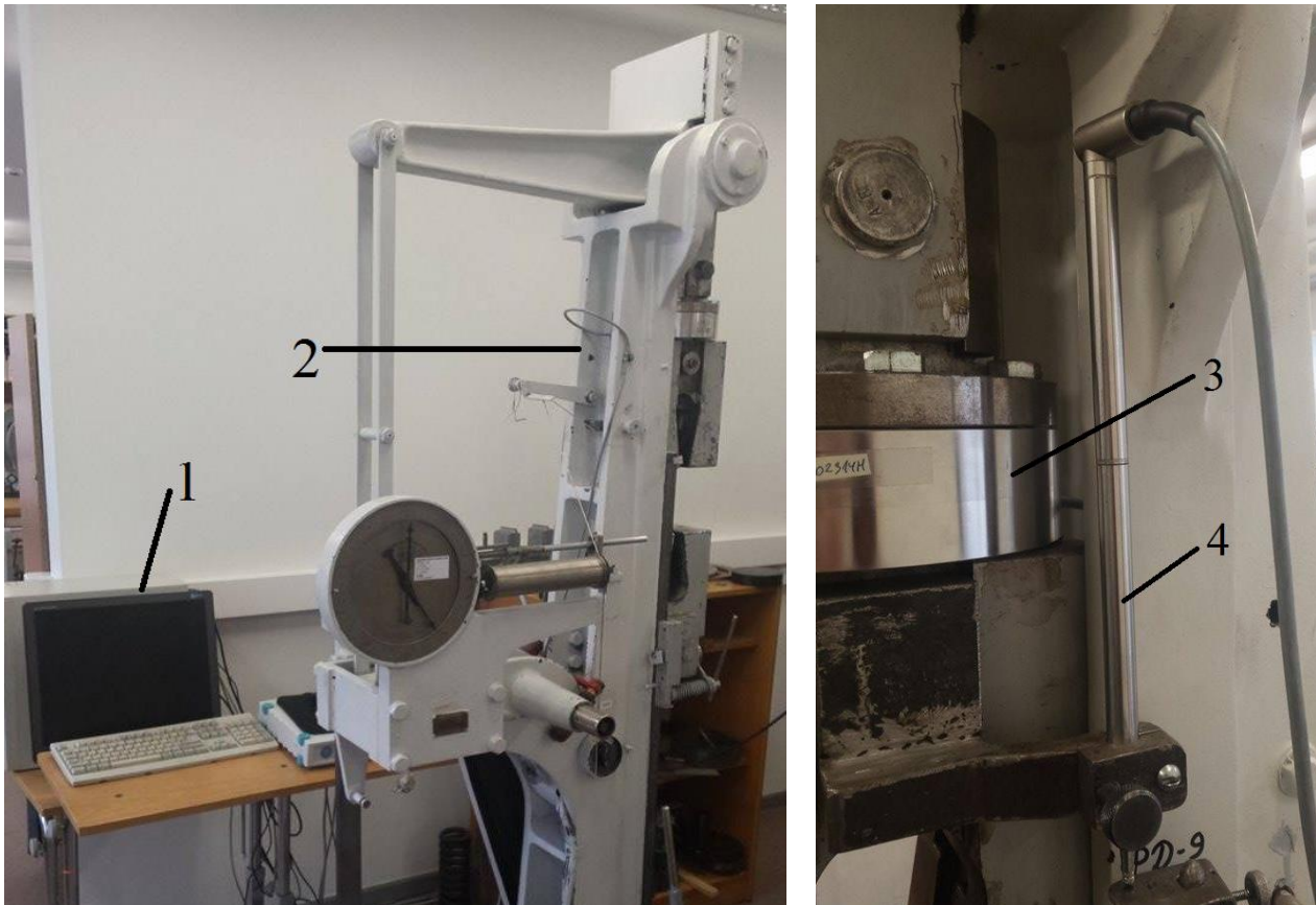
2.4 pav. Eksperimentinių tempimo bandymų sistema: 1 – kompiuteris su duomenų registravimo sistema; 2 – universali bandymų mašina; 3 – jėgos jutiklis; 4 – poslinkio jutiklis
