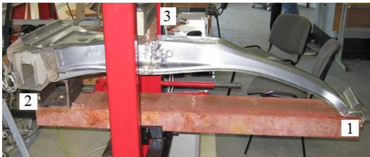
2.15 pav. Statramsčio konstrukcijos apkrovimo schema: 1 – viršutinės dalies atrama; 2 – apatinės dalies atrama; 3 – hidraulinis spaudimo cilindras
