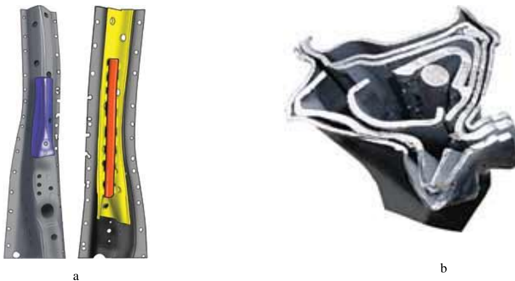
1.11 pav. Subaru B – statramsčio konstrukcija [29]: a – stiprinantys elementai; b – perpjautos konstrukcijos vaizdas
