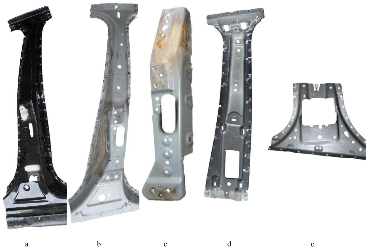
3.1 pav. Statramsčio konstrukciją sudarantys elementai: a – išorinis profilis; b – vidinis (stiprinantis) profilis; c – tvirtinimo elementas; d – galinio profilio viršutinė dalis; e – galinio profilio apatinė dalis.
